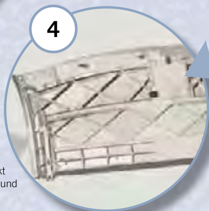
Smält magnesium eller aluminium skjuts in med högt tryck i en gjutform
